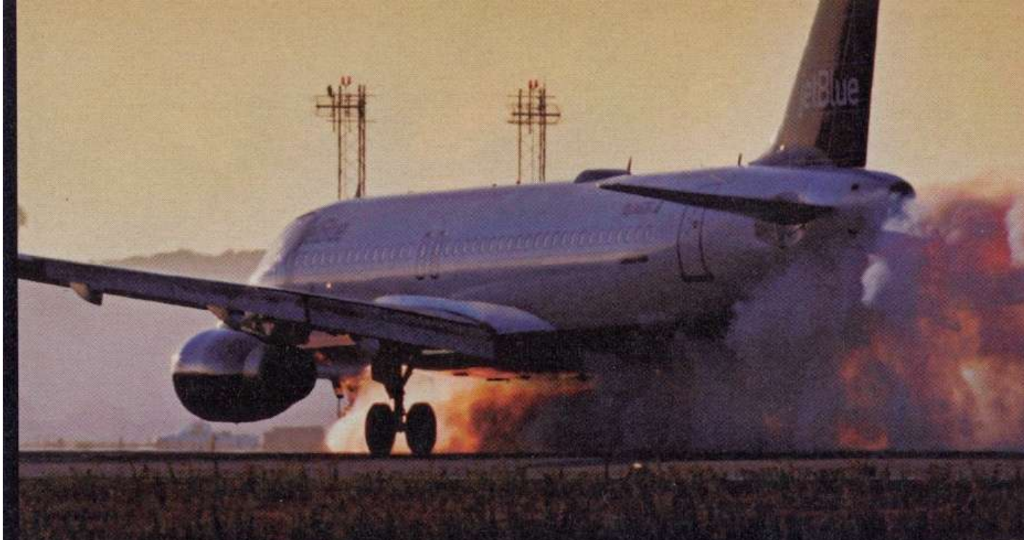
Os pneus dianteiros pegaram fogo quando tocaram o chão na aterrissagem.
